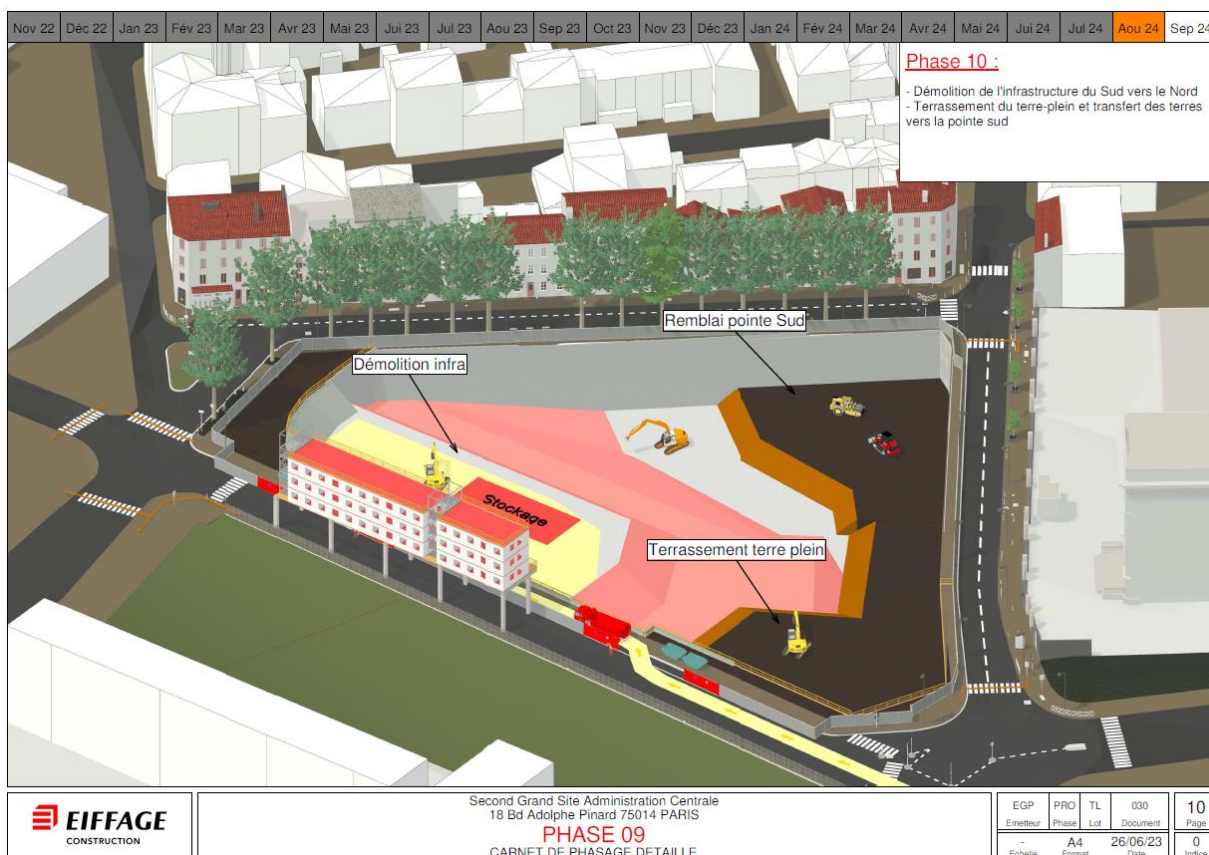
Figure 167 : Phase 1, 2 et 9 de la déconstruction (Source : carnet de phasage détaillé désamiantage – démolition)
